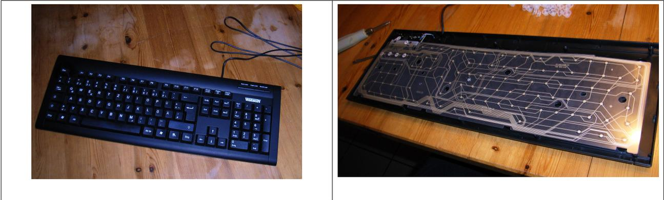
Doch wie funktioniert eigentlich so eine Tastatur? Zuerst schraubst du die Tastatur auseinander und schaust dir das Innenleben genauer an. Du findest vermutlich ein paar Folien, Gumminüpsel und eine Platine, die die Ansteuerung des USB-Anschlusses übernimmt. Das sieht bei jeder Tastatur etwas anders aus. Du musst bei deiner Tastatur also schauen, wo du die entsprechenden Komponenten wiederfindest.
